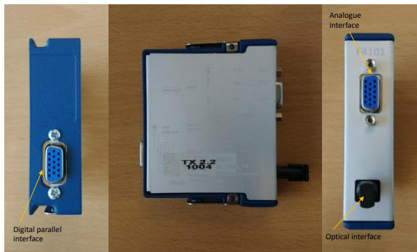
Fig. 5. Hotlink module TX.
